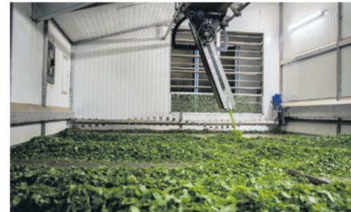
In der Trocknungsanlage kann auf mehreren Ebenen getrocknet werden. Schnell und schonend soll das vor sich gehen, damit die Qualität der Blätter nicht leidet. Getrocknet wird bei etwa 43 Grad Celsius, die Dauer variiert je nach Art zwischen sechs Stunden und zwei Tagen.
