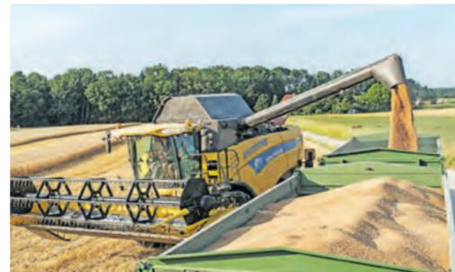
Wenn das Getreide reif ist, wird es mittels Mähdrescher geschnitten und das Korn aus den Ähren gedroschen. Die Ernte erfolgt, je nach Witterungsverlauf und Standort, zwischen Mitte Juni und Ende August.
