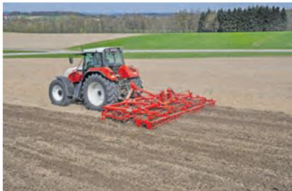
Bevor der Bauer das Getreide anbaut, muss er den Boden dafür so vorbereiten, dass eine feinkrümelige Oberfläche entsteht. Die optimale Saatbettbereitung: so leicht wie möglich, so tief wie nötig.
